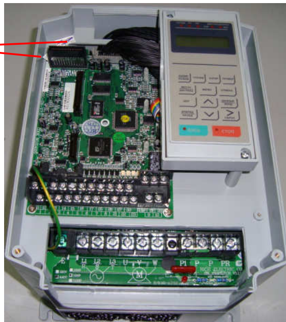
Рис. 8.3. Положение ремонтных гарантийных наклеек.
