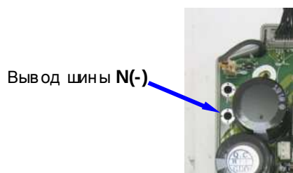
Рис. 4.7. Вывод шины N(-) на плате драйверов
