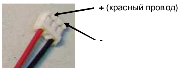
Рис. 4.11. Разъем кабеля питания вентилятора
