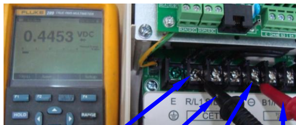
Клемма R Щуп COM прибора Клемма Θ Щуп Ω прибора
