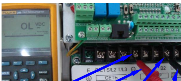
Клемма Θ Щуп Ω прибора Клемма B2 Щуп COM прибора
