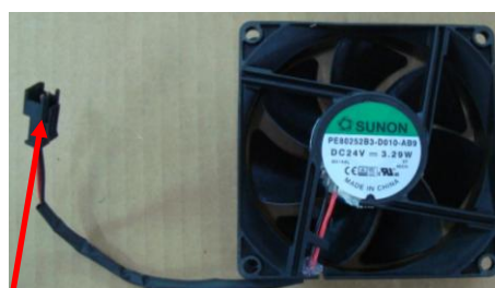
Разъем вентилятора Рис 4.13. Диагностика вентилятора.
