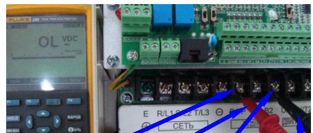
Клемма V1/P Щуп Ω прибора Клемма B2 Щуп COM прибора
