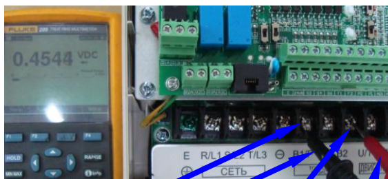
Клемма V1/P Щуп COM прибора Клемма B2 Щуп Ω прибора
