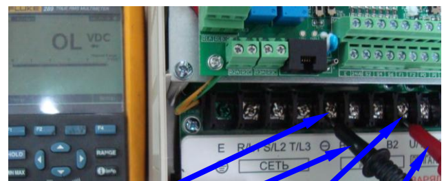
Клемма Θ Щуп COM прибора Клемма B2 Щуп Ω прибора
