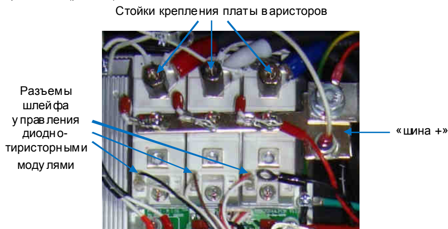
Рис. 4.5. Расположение диодно-тиристорных модулей.
