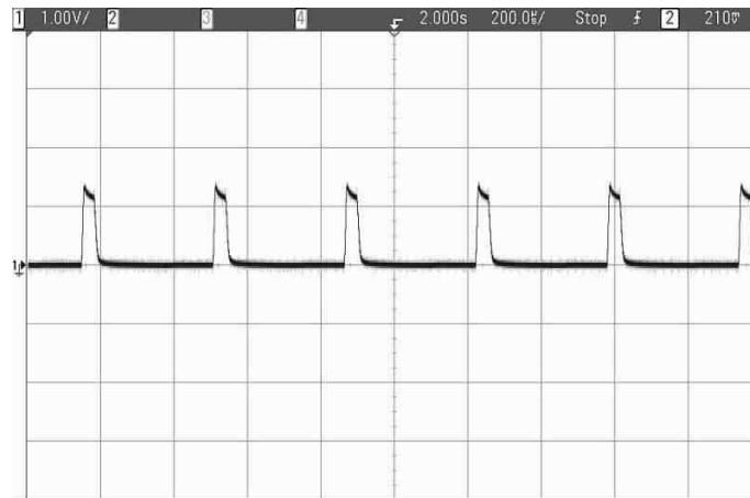
Рис. 4.15. Осциллограмма у прав ления диодно-тиристорным моду лем (200 мкс/дел).
