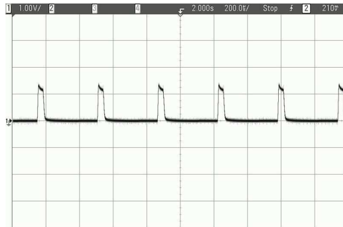
Рис. 4.15. Осциллограмма управления диодно-тиристорным модулем (200 мкс/дел).
