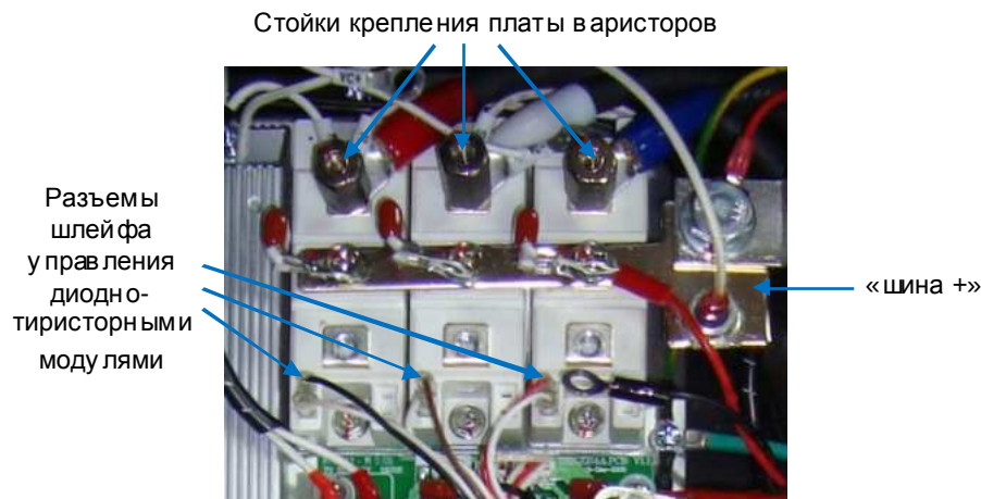
Рис. 4.5. Расположение диодно-тиристорных модулей.
