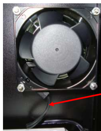
Рис. 6.23. Демонтаж бокового вентилятора.
