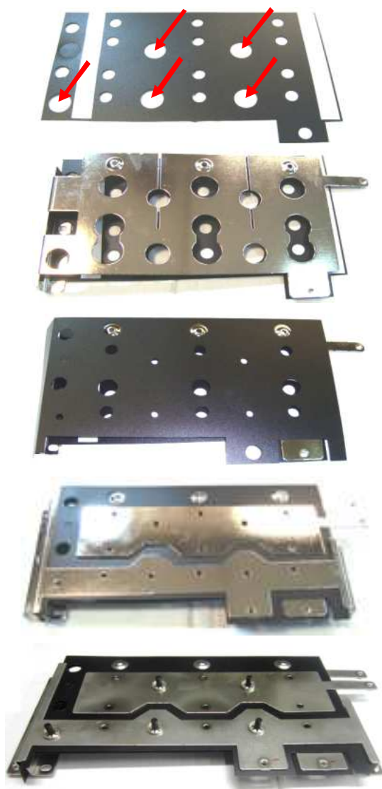
Рис. 7.12. Порядок сбора шин «+» и «-»ЗПТ.
