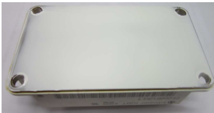
Рис. 7.6. Нанесение теплопроводного компаунда на основание силового модуля.
