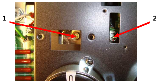
Рис. 7.18. Подключение выводов «+» и «-».
