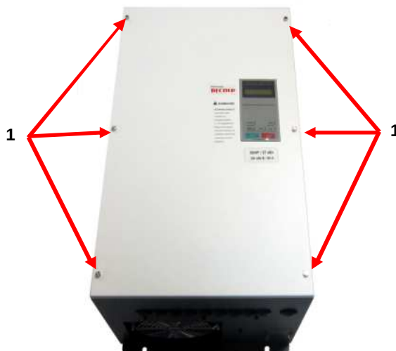
Рис. 6.1. Демонтаж крышки преобразователя. 1 - винты крепления крышки.
