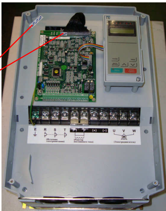
Рис. 8.3. Расположение гарантийных наклеек (ремонтных).
