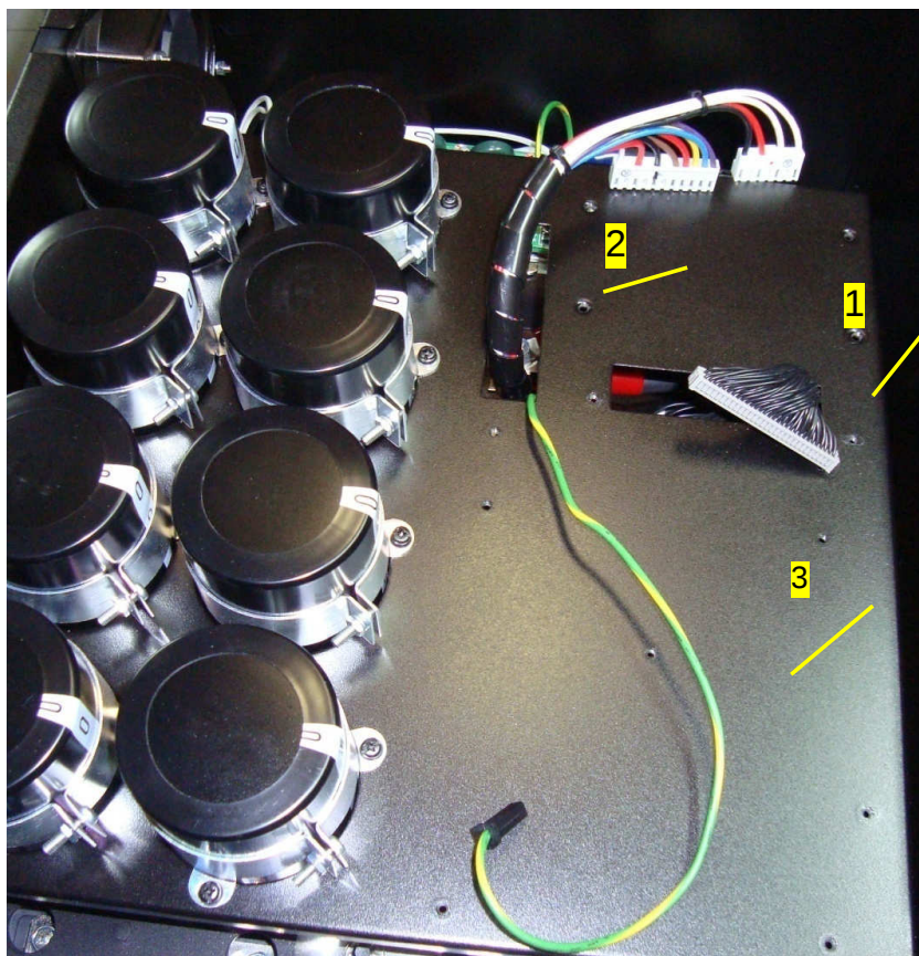
Рис. 7.13 1 – жгут платы ЦП; 3 – провод заземления. 2 – жгут платы предохранителей;
