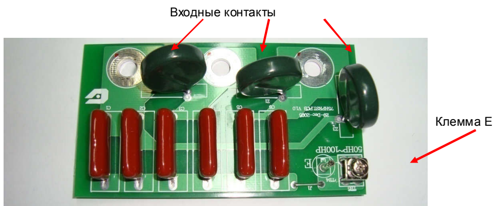
Рис. 4.15. Диагностика платы варисторов
