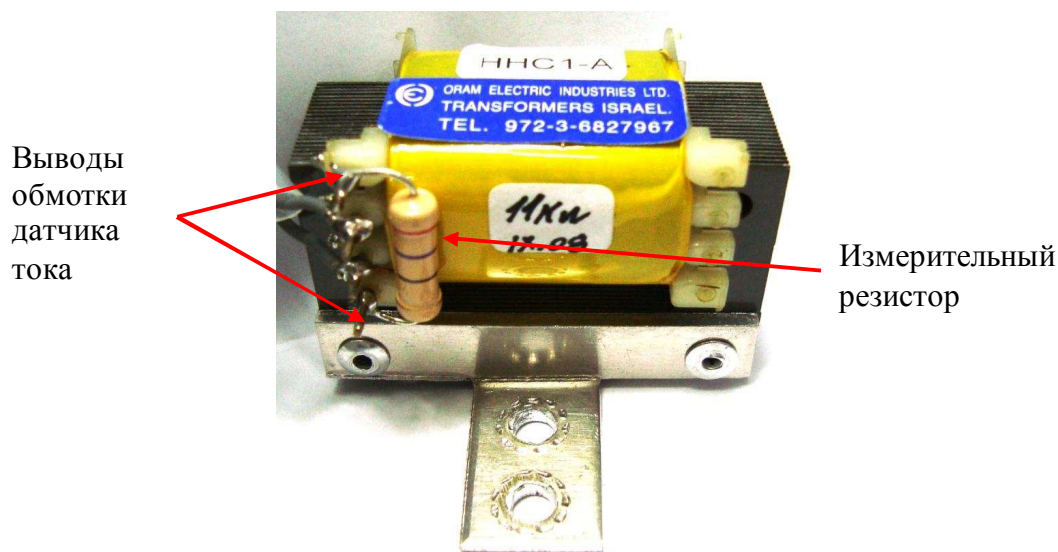
Рис. 4.14. Диагностика датчика тока.
