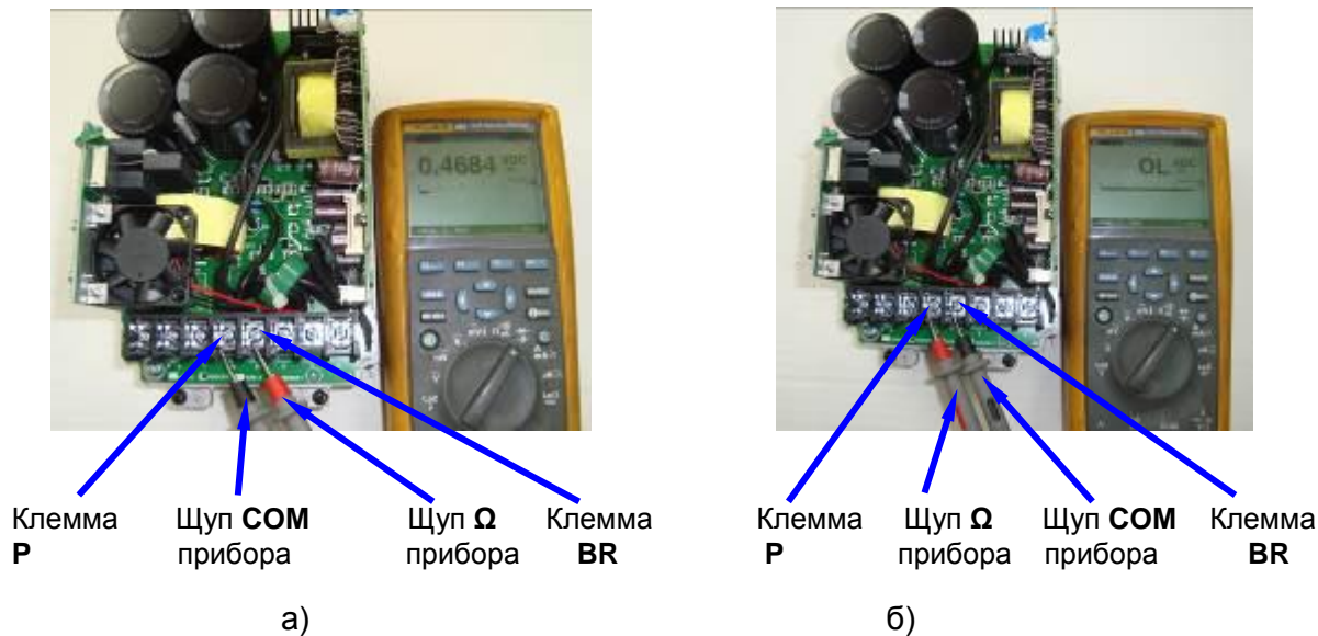
Рис. 4.8. Проверка защитного диода в цепи тормозного ключа матрицы IGBT.
