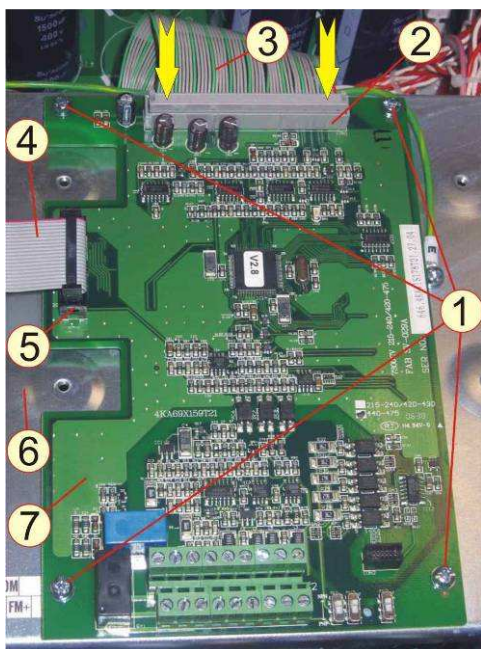
Рисунок 7.6 – Установка платы центрального процессора:
