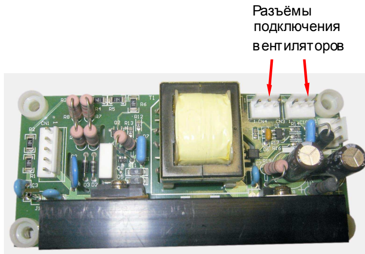
Рис 4.15 Плата питания вентиляторов
