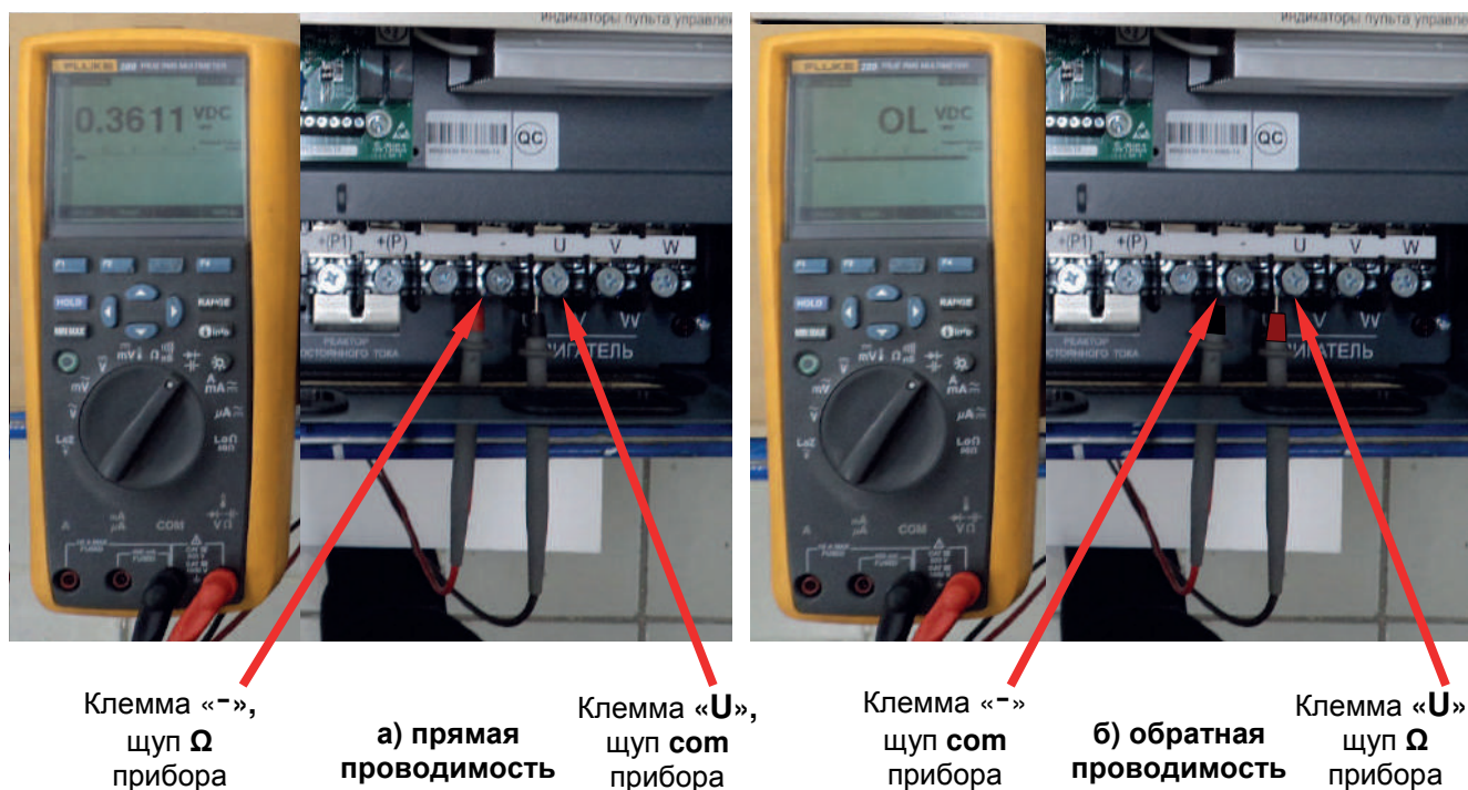
Рис 4.9. Диагностика выходных силовых цепей относительно клеммы «-».
