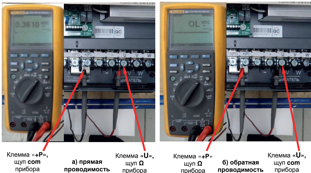
Рис 4.8. Диагностика выходных силовых цепей относительно клеммы «+P».
