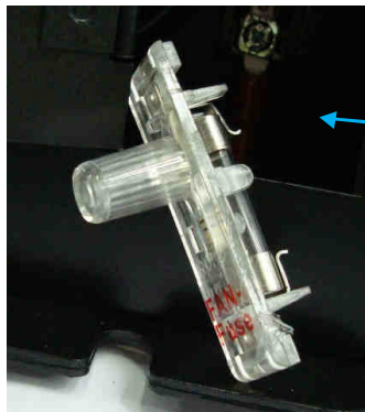
Предохранитель вентиляторов охлаждения радиатора. Подключение щупов прибора.
