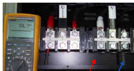
Щуп COM прибора к клемме (-)
