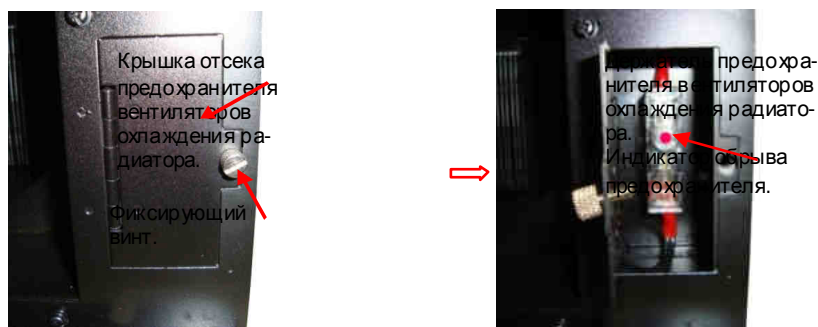
Рис. 4.26. Предохранитель цепи питания вентиляторов охлаждения радиатора
