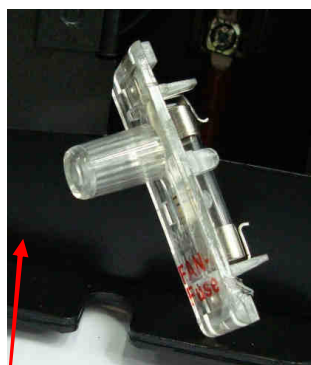
Предохранитель вентиляторов охлаждения радиато- ра. Подключение щупов прибора.
