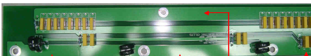
Измерить сопротивление между каждой парой сигнальных контактов R, S, T.
