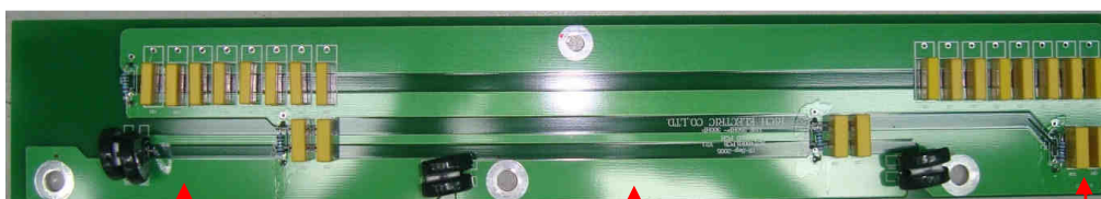
Измерить сопротивление между каждой парой сигнальных контактов R, S, T.
