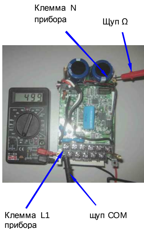
Рис 4.7. Диагностика матрицы относительно клеммы N
