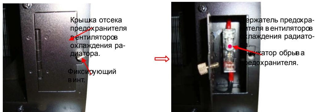
Рис. 4.26. Предохранитель цепи питания вентиляторов охлаждения радиатора
