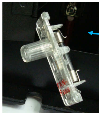
Предохранитель вентиляторов охлаждения радиатора. Подключение щупов прибора.
