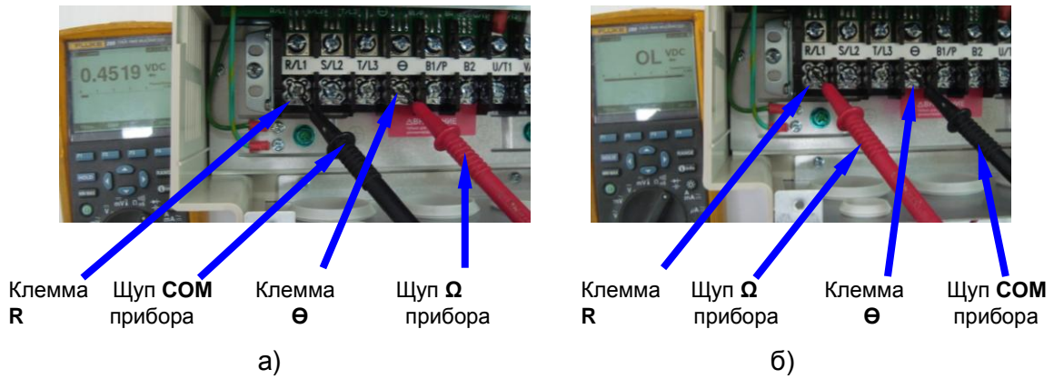
Рис 4.6. Диагностика матрицы IGBT относительно шины \Theta (минус).
