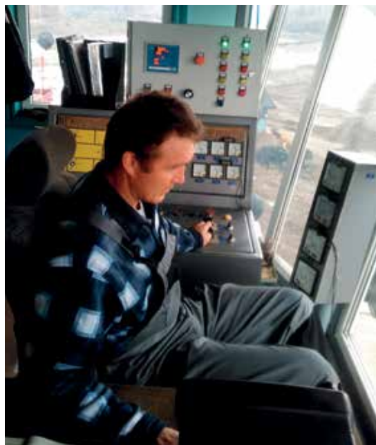
Рис. 1. Стационарный пульт на мостике для управления всеми агрегатами драги
