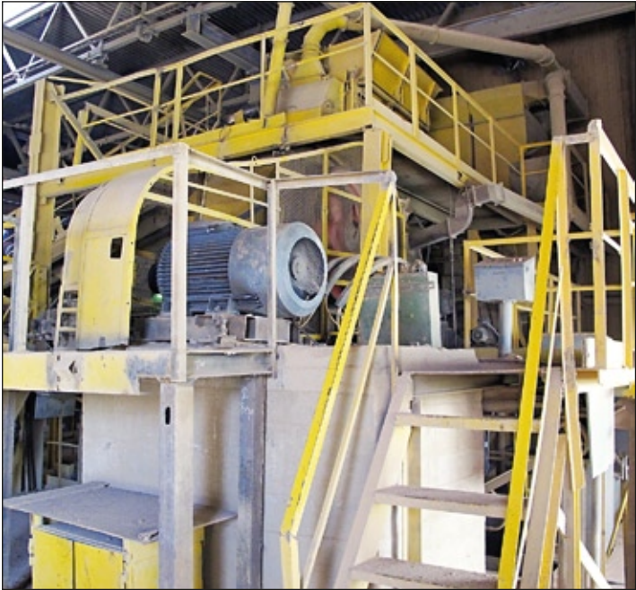
Фото слева: Плавный пуск привода грубого помола обеспечивает ДМС мощностью 160 кВт. Фото в центре: Привод вентилятора сушильного барабана. Фото справа: Устройства плавного пуска вальцов тонкого помола.
