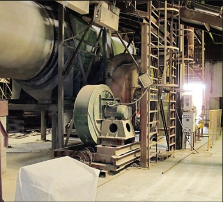
Фото слева: Плавный пуск привода грубого помола обеспечивает ДМС мощностью 160 кВт. Фото в центре: Привод вентилятора сушильного барабана. Фото справа: Устройства плавного пуска вальцов тонкого помола.
