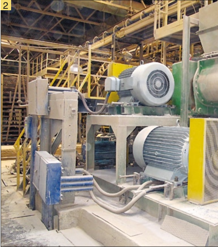
Технология изготовления кирпича в фотографиях: 1. Шепелин В.Н. — Вот он трудяга EI-9011 привода шнека, 2. Привод шнека и мешалки, 3. Приладка главного пресса, 4. Пуск пресса, 5. Глиняный брус готов к нарезке, 6. Готовая продукция направляется на отгрузку потребителю
