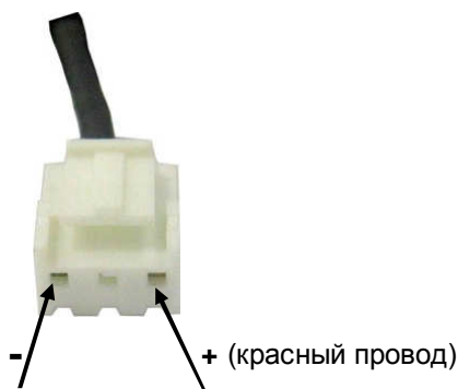
Рис 4.10. Полярность разъёма питания вентилятора.
