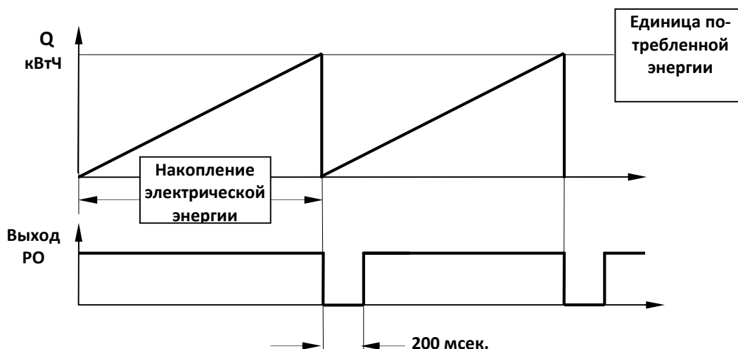
Диаграммы импульсного выхода учёта электроэнергии.
