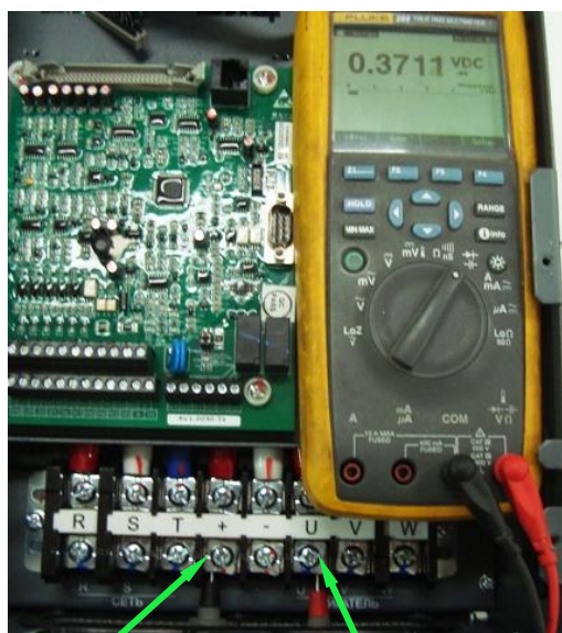
Клемма «+» Щуп «COM» прибора
