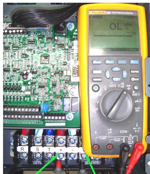
Клемма «+» Щуп «Ω» прибора
