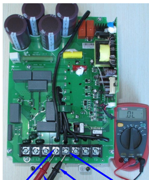
Клемма P Щуп Ω прибора Щуп COM прибора Клемма BR
