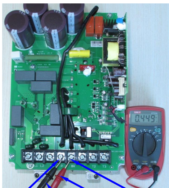
Клемма P Щуп COM прибора Щуп Ω прибора Клемма BR
