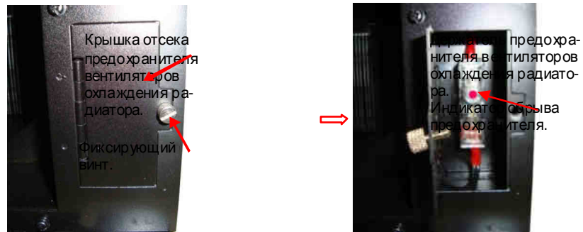
Рис. 4.25. Предохранитель цепи питания вентиляторов охлаждения радиатора
