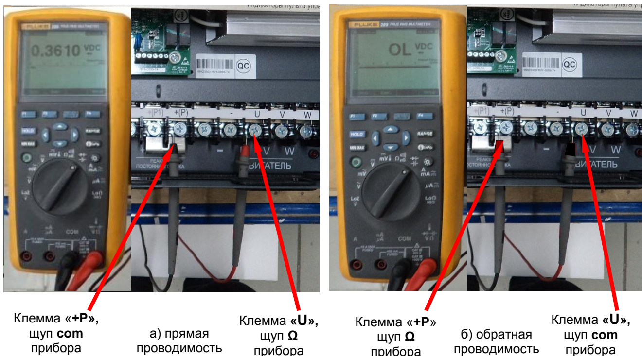
Рис 4.8. Диагностика выходных силовых цепей относительно клеммы «+P».
