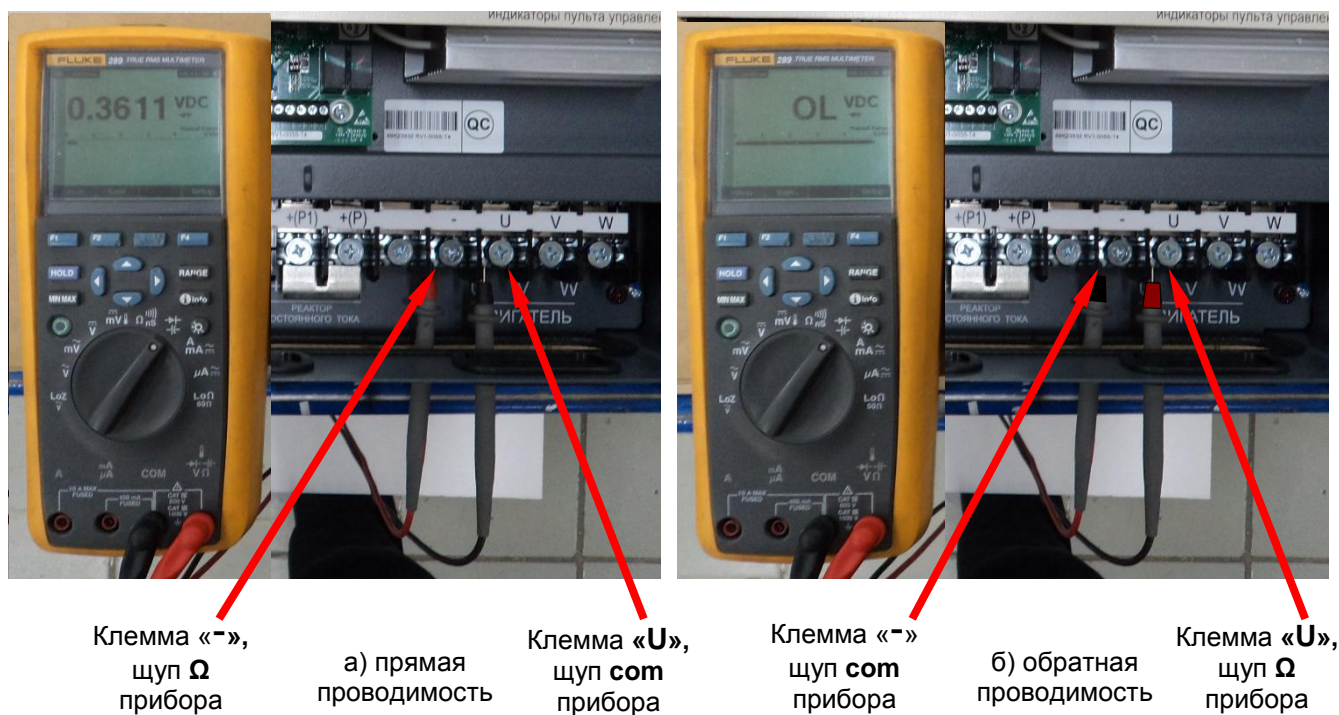
Рис 4.9. Диагностика выходных силовых цепей относительно клеммы «-».
