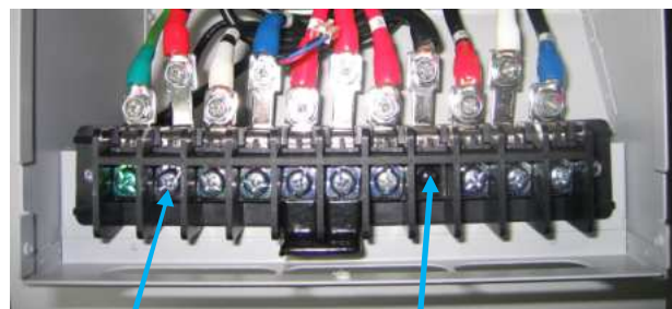
Клемма « R/L1 » Щуп « Ω » прибора Клемма « N » Щуп « COM » прибора
