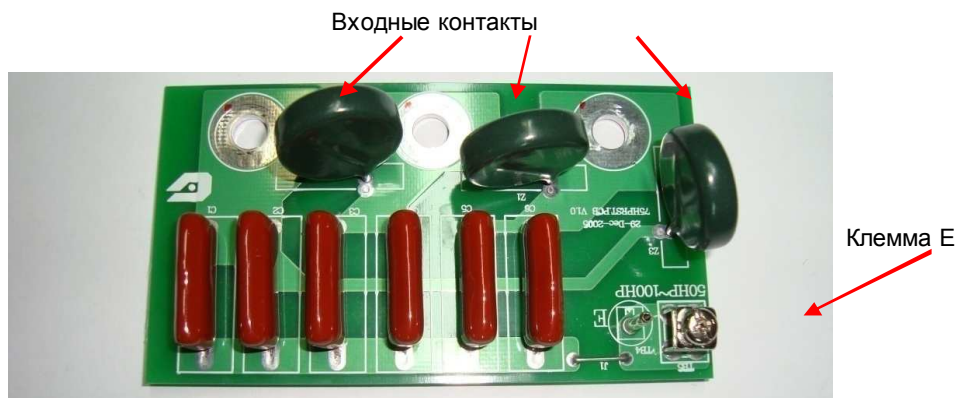
Рис. 4.15. Диагностика платы варисторов
