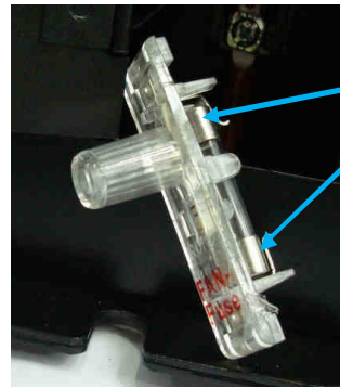
Предохранитель вентиляторов охлаждения радиатора. Подключение щупов прибора.
