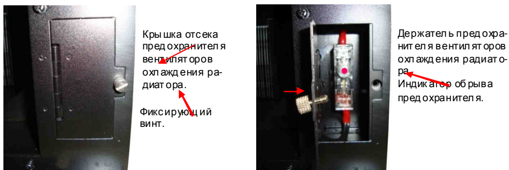
Рис. 4.26. Предохранитель цепи питания вентиляторов охлаждения радиатора
