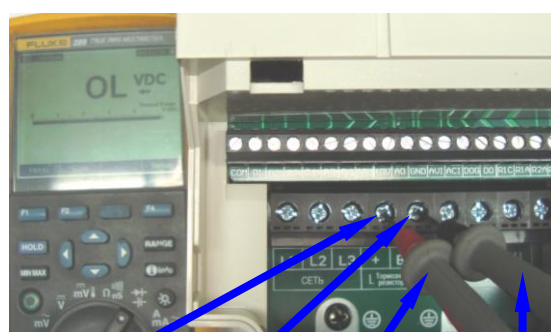
Клемма + Клемма BR Щуп Ω прибора Щуп COM прибора
