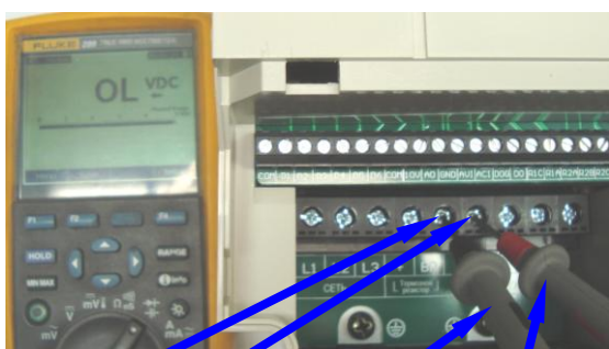
Клемма BR Клемма - Щуп COM прибора Щуп Ω прибора
