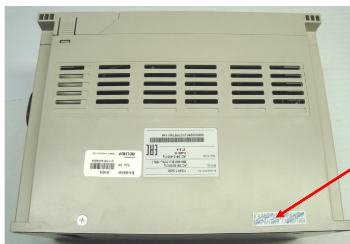
Рис. 8.3. Положение ремонтных гарантийных наклеек.
